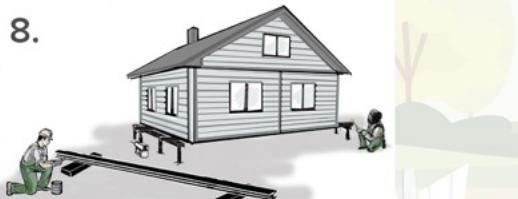
Двутавровую балку предварительно прокрашивают и прокладывают под дом. Затем ее приваривают к швеллеру.
