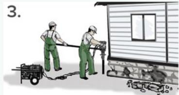
Бригада монтирует винтовые сваи по 2-м сторонам дома. Сваи монтируются ручным или механическим способом на глубину не менее 1,6м - ниже глубины промерзания по Московской области.
