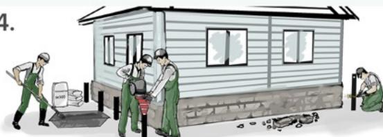
Винтовые сваи обрезают в нужный уровень, далее сваи заполняют пескобетоном марки М-300, чтобы исключить воздух из полости сваи и свая не будет кородироваться.
